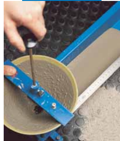
Prueba de escurrimiento según la EN 13395-2
